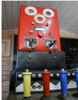
Giugno 2009, - Istrumento di blocco e leve di comando all'interno del vagone storico "ufficio movimento".
