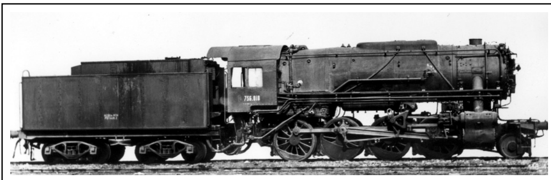
Locomotiva 736.110 di origine statunitense a San Benedetto del Tronto alla fine degli anni Quaranta, e visione laterale della 736.010. La posizione del forno sopra le ruote motrici ha imposto una posizione più alta per la caldaia (ed il baricentro) di queste macchine. (Foto FS).
