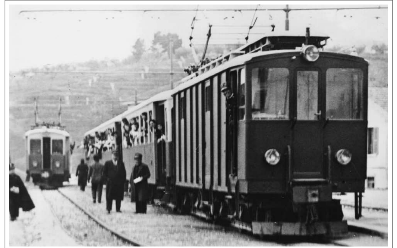
Stazione F.E.A. di Loreto Aprutino. Tifosi della squadra pennese in partenza dopo il derby calcistico tra Loreto e Penne. In primo piano si nota un convoglio trainato da un locomotore-bagagliaio (ancora in livrea nera d'origine) con tre vetture rimorchiate. - Archivio personale Achille Rasetta.
