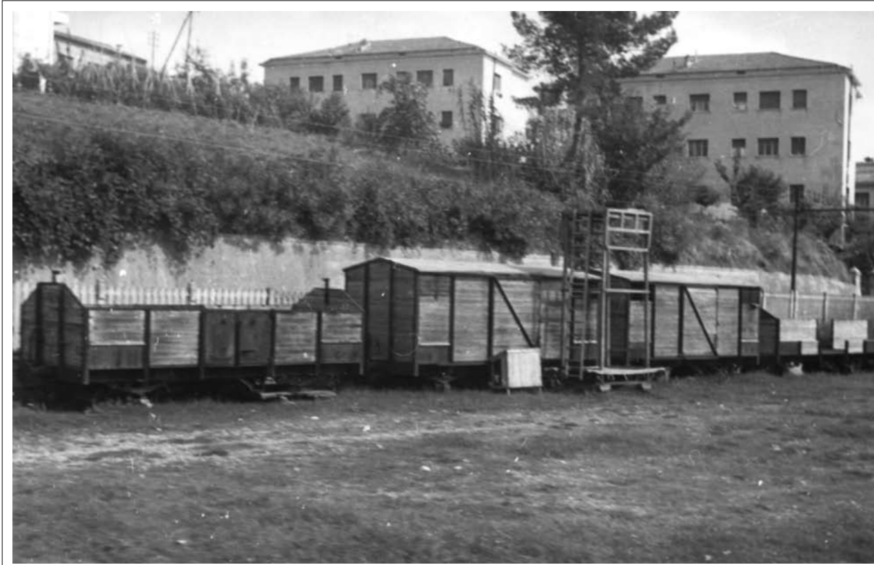
Dicembre '60 - Carri merci del tipo "chiuso" ed a "sponde alte" accantonati nel secondo binario tronco del piazzale merci della stazione di Penne. - Foto Renzo Marini.
