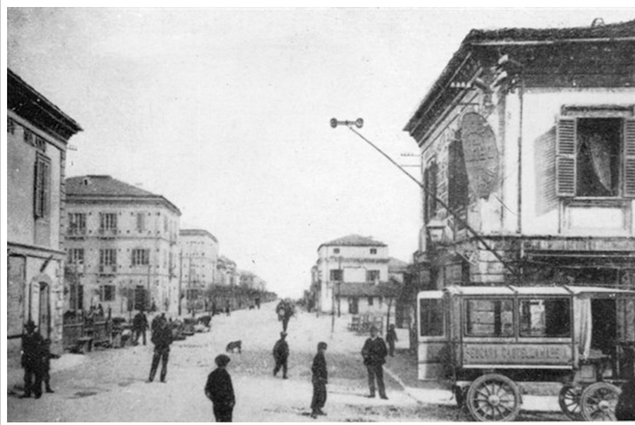
Castellamare Adriatico: filobus sul corso Vittorio Emanuele II diretto a Pescara. E' molto chiaro il carrello Cantono; il trolley appare diverso forse in seguito ai miglioramenti del 1904. Di fronte il corso Umberto I, alla spalle la stazione ferroviaria. (Da cartolina collezione Piero Muscolino).
